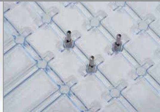
Les premiers prototypes sont thermoformés avec la matière qui servira à la production finale. Nous validons ensemble le prototype. L'empreinte définitive est alors fabriquée et la production de votre produit thermoformé "sur mesure" est lancée.
