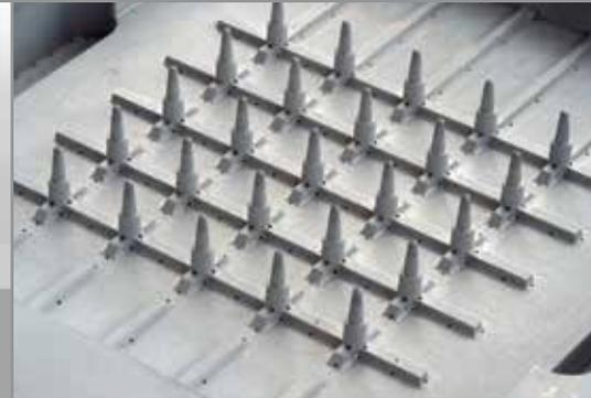
Après validation par vos soins de l'étape précédente, nous fabriquons une empreinte pour réaliser des prototypes. Cette empreinte de prototypage est le reflet précis, à échelle réduite, de ce que sera l'empreinte définitive, et ce, jusque dans les moindres détails.
